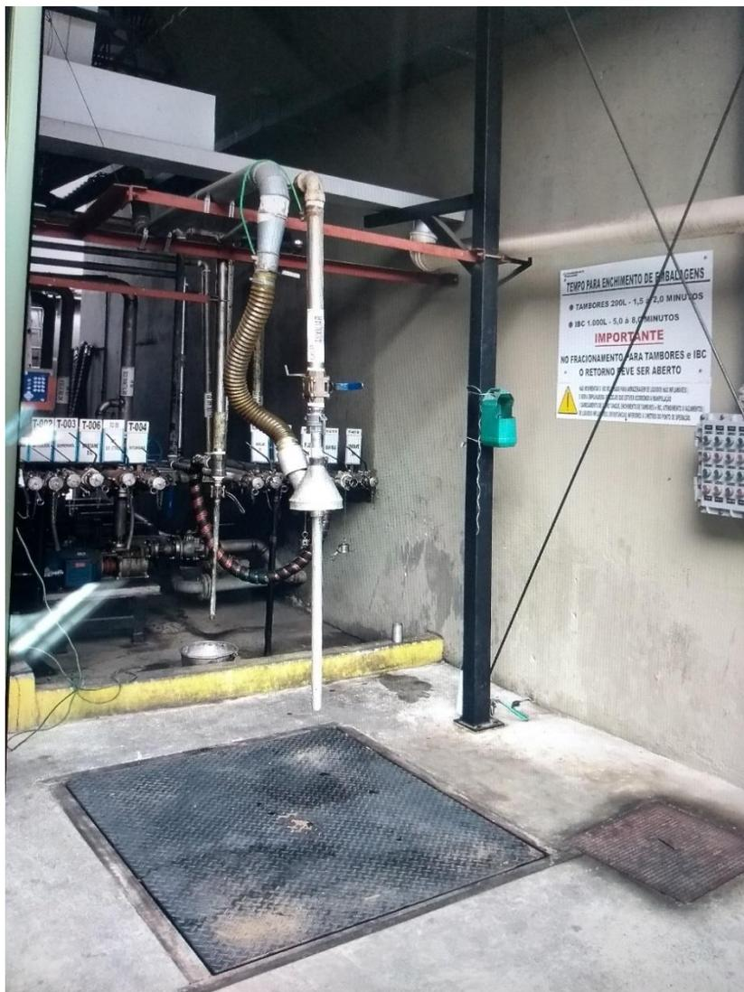
IBC composto sobre a balança, aterrado e pronto para receber o líquido inflamável.
